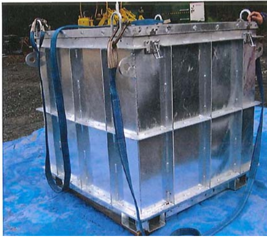
放射線遮蔽コンテナの低減効果試験 (左：側面測量、右：上面測量)
