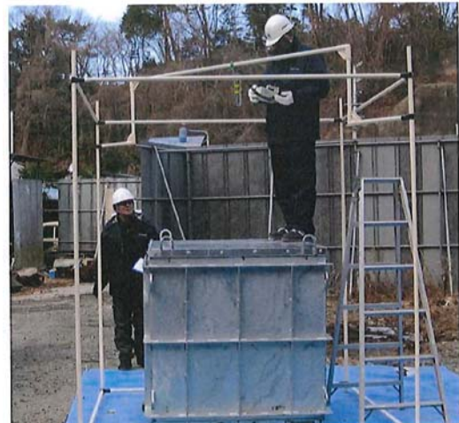
放射線遮蔽コンテナの低減効果試験 (左：側面測量、右：上面測量)
